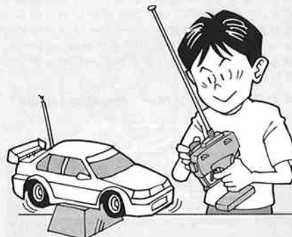
③ 走らせる前にRCカーを台の上に寄せ、各部の動きをチェックします。
