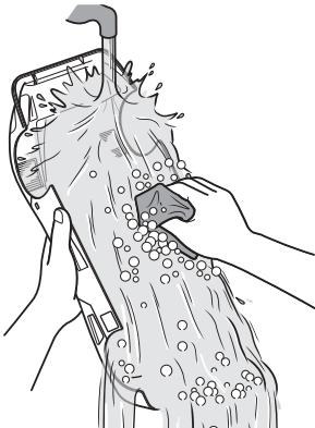
★塗装前に中性洗剤で油気をおとします。水洗いをして洗剤を洗い流して乾かしてください。
