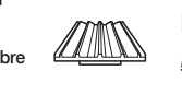
BB6 ×3 50602 ベベルギヤ (小) Small bevel gear Kegelrad klein Petit pignon conique
