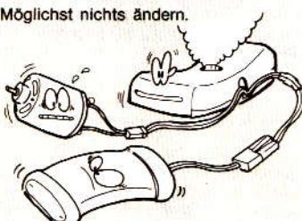
Für diese Einheit darf nur der Tamiya Ni-Cd 7.2V Tampack Akku und der FK-180SH Mini-Black Motor verwendet werden. Verwendung anderer Akkus und Motoren kann die C.P.R. Einheit beschädigen. Niemals die Antenne, C.P.R. Einheit, Stecker oder Servo zerlegen oder in der Verdrahtung ändern, es könnte zu Kurzschluß führen oder Bauteile beschädigen.
