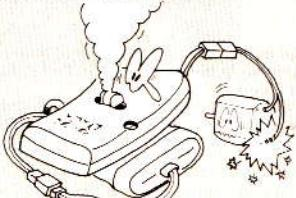
Eine verschlissene Isolation in der Verdrahtung führt zu Kurzschluß, der den Akku und die C.P.R. Einheit zerstört. Beschädigte Kabel sauber mit Vinylband isolieren.
