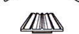
BA28 ×6 50602 ベベルギヤ (小) Small bevel gear Kegelrad klein Petit pignon conique
