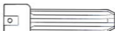
D2 ×2 ドライブシャフトA Drive shaft A Achswelle A Arbre d'entraînement A
