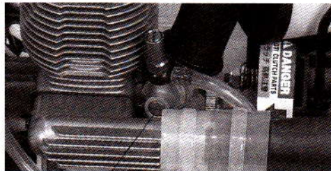
アイドル調整バルブ(フチから1回転締め込んだ位置) Idle adjustment valve (Tighten 1 turn from the edge) Leerlauf-Einstellventil (Von der Ecke aus um 1 Umdrehung einschrauben) Vis de réglage de ralenti (Serrer d'un tour depuis le bord)
