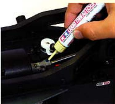
●ネジロック剤はエンジンスターターの取り付けネジおよびプロペラシャフトの緩み止めとして部品交換などしたときに使用します。通常はすでにネジロックされているので使用しません。また指定箇所以外は使用しないでください。
