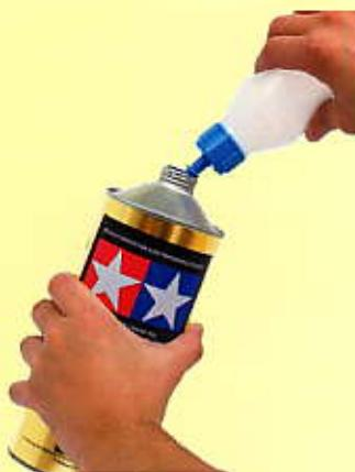
1. 燃料缶から燃料ポンプに移しかえます。図のようにポンプで吸い取ることができます。
