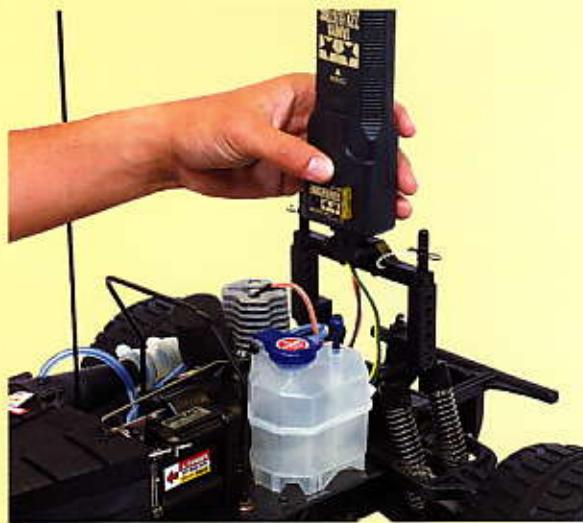
7. RCカーを台の上に乗せ、電動スターターでエンジンを回します。
