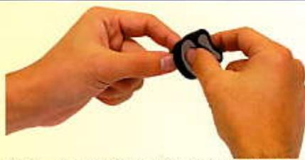
●エアクリーナーが汚れたらエンジンから取り外して中性洗剤を付け手でモミ洗いします。洗浄後はよく水洗いし、陰干してください。エアクリーナーは予備パーツが付属していますので交互に使うと効率よく使用できます。乾燥後はエアクリーナーオイルをしみこませ、エンジンに取り付けます。
