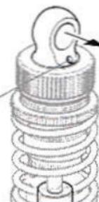
★印側からボルトナットに押し込みます。
