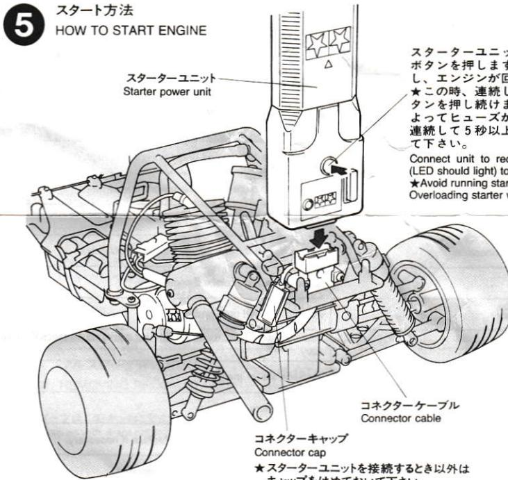
スターターユニットを接続してスタートボタンを押します。LEDランプが点灯し、エンジンが回り、始動できます。
