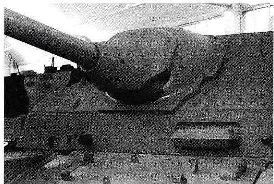
戦闘室は車高の増加とともに側面板が延長され、傾斜角が垂直に近くなりました。装甲厚はラングと変わらず前面80mm、側面40mm、後面30mm。細かい部分では、前面右側のピストルポートカバーが円すい状のものから平板に変わり、戦闘室の四隅に吊り上げ用のフックを追加。上面には“フォアザツツP”と呼ばれる、90度湾曲した銃身が付いたMP44機関銃を装着できるマウントを備えていましたが、実際にはほぼ装備されず、円形のプレートで塞がれました。
