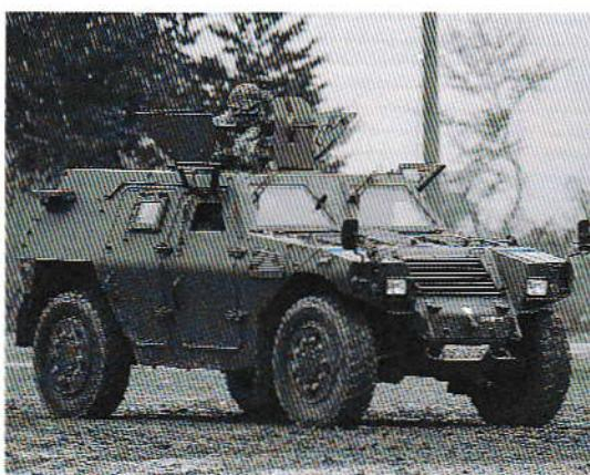
すが、必要とされる装甲防御力を発揮。その強度は前面で12.7mm重機関銃弾、側面で7.62mmライフル弾に耐えるといわれます。車体にはNBC（核・生物・化学）兵器に対する防護が施され、エアコンも装備しています。
