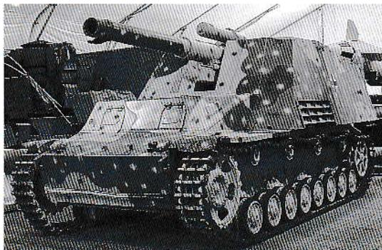
はほとんど同一です。同砲はラインメタル・ボルジヒ社とクルップ社によって1920年代半ばから開発が進められ、1933年に制式化。終戦までに8,000門前後が生産され、第二次大戦を通じてドイツ軍野戦重砲の主力として使用されました。口径149.1mm、砲身長29.5口径、標準的榴弾の重量43.5kg、最大射程は13,325m、発射速度は4発/分です。コンビの軽野戦榴弾砲の10.5cm砲の榴弾重量が、14.81kgしかないことを考えるとその威力の違いは明らかでしょう。なおフンメルの砲弾搭載数は18発です。この少なさは問題で、このためフンメルの車体を流用した弾薬運搬車が製作されて随行しました。
