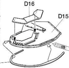
★エッチングパーツ（金属）の接着には瞬間接着剤を使用してください。
