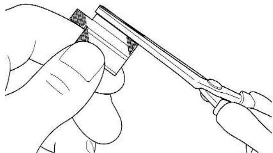
★エッチングパーツ①はエッティングベンダーなどを使って下図のように折り曲げバスケットに組み込みます。
