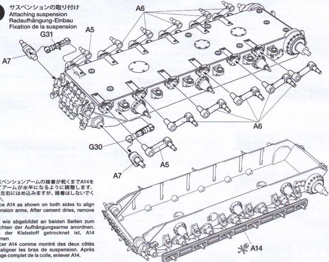
★サスペンションアームの接着が乾くまでA14を使ってアームが水平になるように調整します。A14は左右にはめ込みますが、接着はしないでください。
