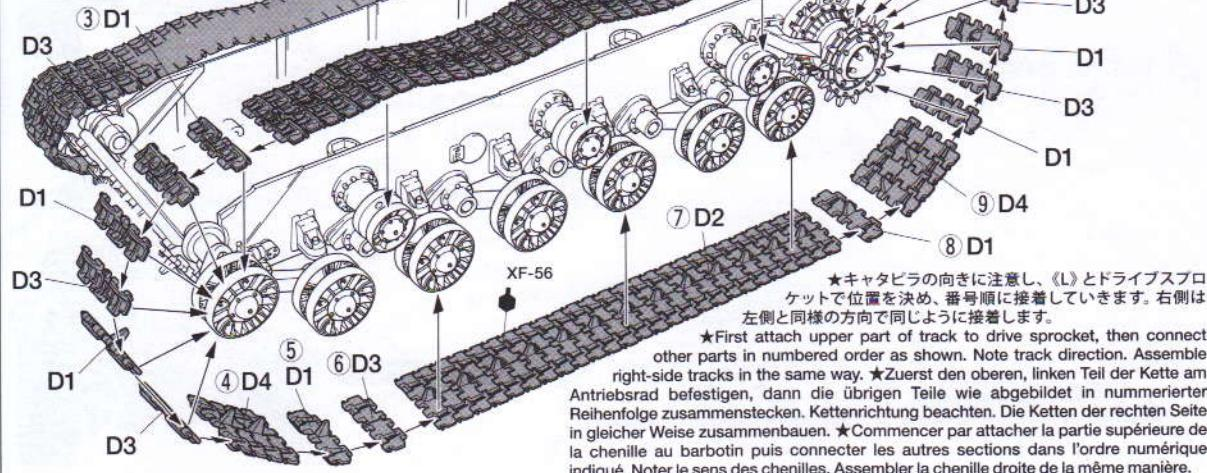
★キャタピラの向きに注意し、《L》とドライブスプロケットで位置を決め、番号順に接着していきます。右側は左側と同様の方向で同じように接着します。
