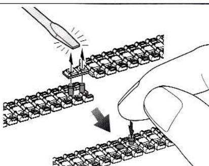
●Ramollir avec précaution les ergots à l'aide d'un tournevis etc... passé à la flamme puis les écraser avec un doigt.
