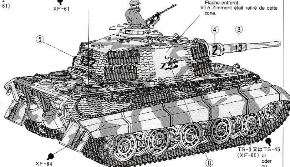
\* 1944年 8月～1944年11月まで生産された車両はすべてツィメリットコーティングが工場出荷時に施されています。11月以降の車両にはツィメリットコーティングが施されていません。
