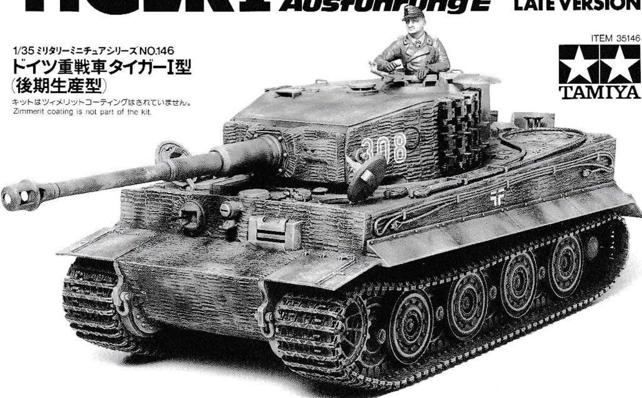
ドイツ軍のタイガーI重戦車は、第二次世界大戦を通じて最も評判の高かった兵器の一つと言っても、言い過ぎでは無いでしょう。このタイガーI重戦車は、生産が開始されてから、ほぼ2年半を経た1944年1月、後期型が生産に入りました。ヘンシェル社が製造した最高で100mmもの装甲板を組み合わせて溶接した強固なタイガーIの車体構造は、後期型になっても変わっていませんでしたが、トーションバー懸架装置の大転輪はゴム・リムつきから、ボルシェ・タイガーで経験済みのゴム・リング板を2枚のプレス鋼板でサンドイッチした構造の大転輪に替りました。装備で進歩したのは砲塔でした。まず、指令塔の点視孔は7個のペリスコープとなり、装填手用のハッチの前には、前方を監視するペリスコープが付けられました。
