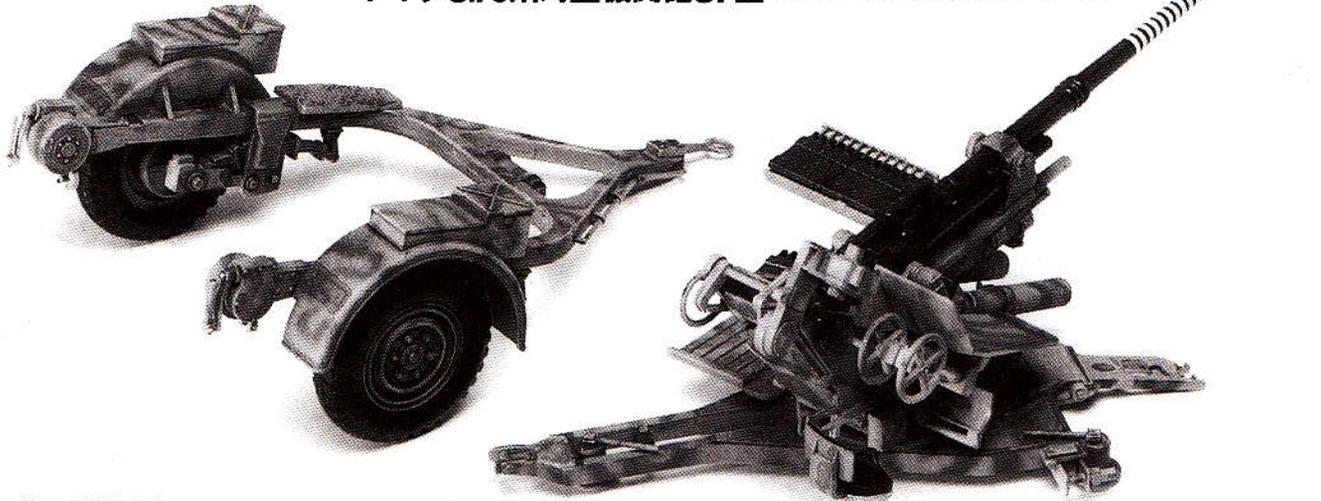
第2次世界大戦においてドイツ軍が投入した3.7cm対空機関砲は、対地、対空の両面で大いに活躍。Flak18から発展したFlak36とFlak37があり、戦争後期にゼンマイ動力付照準器、37型(Flakvisier37)を装備したのが3.7cmFlak37です。ツァイス製の照準器はいったん目標の射程、速度などを手動でセットすると後は照準器の視野の偏差は自動的に十字線が修正される望遠式でした。連続射撃はバネ作動により、弾薬は6発グリップ弾倉を採用。最高発射数は毎分160発、通常時80発、最大射角85度、俯角-5度の性能を持っていました。空軍に配備されたこれらの砲は、対空防衛に活躍したほか、戦争末期には3.7cmStielgranate 41, 42(柄付徹甲榴弾41, 42型)を砲に先込めして発射し、対戦車戦闘など、地上戦闘でも活躍。また一部は、8トンハーフトラックなどの車両に搭載され、自走化されて活躍したのです。
