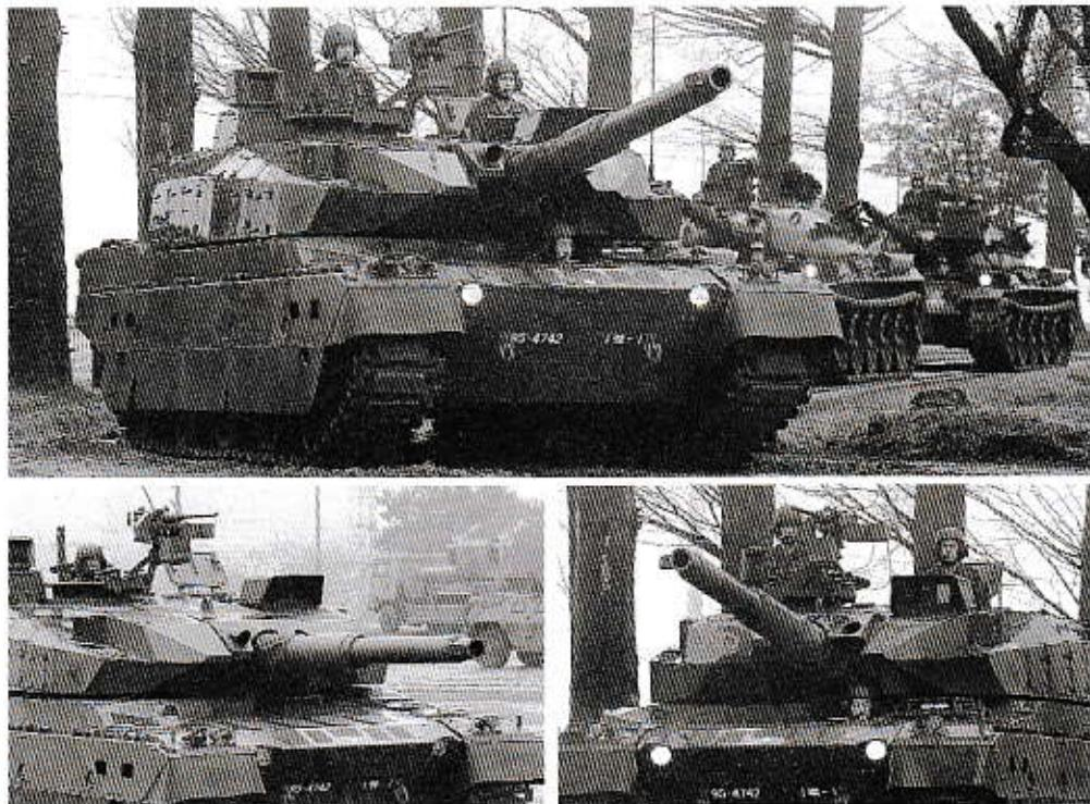
将来の能力向上に対応できる拡張性も確保。パワーユニットはコンパクトに仕上げられた出力1,200馬力のV型8気筒ディーゼルターボエンジン。無段階自動変速機を組み合わせ、優れた機動力を実現しています。サスペンションは車体を前後、左右、上下に姿勢制御できる全油圧式。さらに、車体や砲塔に脱着式のモジュール装甲を採用して防御力と運用性
