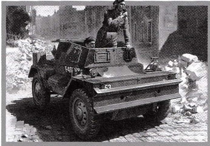
1938年、イギリス陸軍者は、小火器と防御装甲、機動力を兼ね備え、前線での威力偵察も行える軽装甲車の開発をメーカー各社に指示しました。これに基づき3社が試作車を作製し、実用試験の結果採用されたのが、後に前線部隊でオーストラリアの野犬を意味する“ディンゴ”的愛称で親しまれた装甲偵察車です。全長3.18m、全幅1.72mと極めてコンパクトで、コイルスプリングを使用したウィッシュボーン式懸架装置や、プレセレクターギヤボックスと流体フライホイールを採用した前後各5段のトランスミッション、旋回半径を小さくする4輪操舵システム、デファレンシャルボックスから4輪それぞれにプロペラシャフトを配した駆動系など、先進的に優れた機構が盛り込まれていました。車体後部には55馬力の6気筒ガソリンエンジンが搭載され、路上での最大速度は89km/h。乗員は車長と操縦手の2名で、車長は必要に応じて前面の射撃ポートから7.7mmブレン軽機関銃を射撃することができました。ディンゴは
