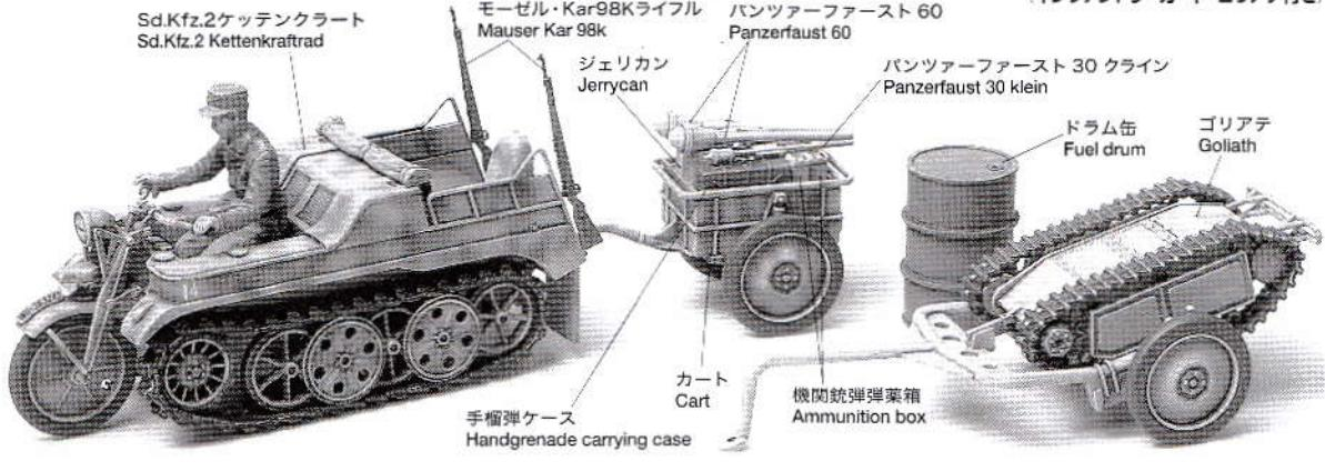
● **Sd.Kfz.2ケッテンクラート** : 第二次大戦中にドイツ軍が多用したハーフトラックの中で、本来、空挺部隊用の小型多用途牽引車としてNSU社によって開発されたのがSd.Kfz.2、ケッテンクラートです。ケッテンクラートは36馬力のオペル・オリンピア水冷直列4気筒1478ccエンジンと前進3段、後進1段のトランスミッション、2スピードの副変速機、そしてトーションバー式サスペンションなどを装備。1941年から1944年までに8,345輌が生産され、優れた路面走破性能と牽引能力を活かして、火砲やトレーラー、そして航空機の牽引など幅広い戦線で使用されました。
