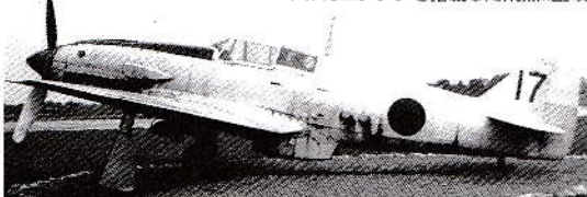
ハ140エンジンを搭載した飛燕II型改
