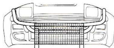
★ネットは下図の大きさに切り出し、上図のように取り付けて下さい。
