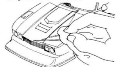
5 Mit Stoff Luftblasen herausdrücken, überflüssiges Wasser aufsaugen. Wenn Fläche uneben oder gebogen ist, Bild mit nassem heissem Tuch aufdrücken.
