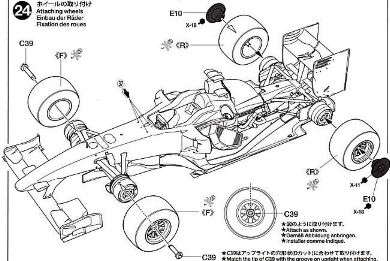
★C39はアップライトの穴形状(Dカット)に合わせて取り付けます。
