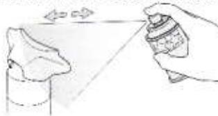
す、塗装する物を空きカンなどに固定し、20cmくらいはなして塗料を吹きつけます。スプレーの缶をすばやく同じ方向に動かしてシュッシュッと吹きつけるようにしてください。塗装する物よりひと回り大きな物に
