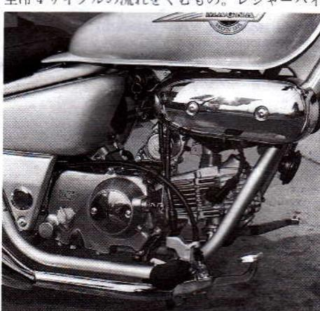
クの草分けとなったモンキー、ゴリラ、ダックスなどとも同様に水平に搭載されています。高い信頼性を誇るエンジンは粘り強く、低速域でも十分なトルクを発生し、しかも高回転までスムーズに回るフレキシブルさを発揮。もちろん、エンジン始動が簡単なセルスターターを装備しているのは言うまでもありません。また、クランクケースカバーはバフクリア仕上げが施され、エンジンまでもハイクオリティなムードを演出しています。そして、迫力あふれる大口径のショットガンマフラーからは深みのあるエキゾースト・サウンドが響きクルージングの爽快さを高めています。
