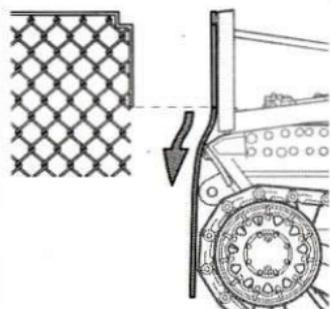
★曲げ、たわみなどの加工が容易にできます。図のように前面装甲に沿わせるように曲げます。
