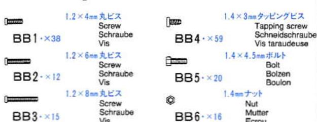
BB1 ×38 1.2×4mm 丸ビス Screw Schraube Vis
