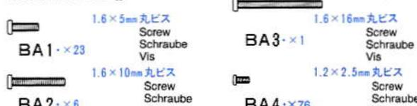
BA1 ×23 1.6×5mm 丸ビス Screw Schraube Vis
